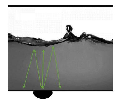
Сенсор устанавливается снаружи резервуара, в самой нижней его точке
