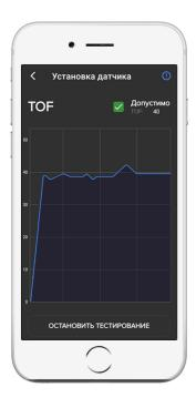
KS2 PROP-BT — это ультразвуковой датчик уровня, подключающийся к смартфону по Bluetooth Low Energy.
