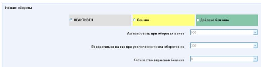
**НЕАКТИВНО** – при активации этой функции в режимах низких нагрузок и малых оборотов двигателя автомобиль работает на газе.
