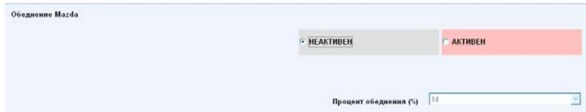
Для обеспечения правильной работы системы на таких моторах и обеспечения правильного состава смеси активируйте функцию.
